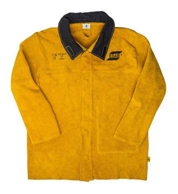
Die Jacke aus 100 % Spaltleder bietet den ultimativen Schutz vor Schweißspritzern und geschmolzenen Materialien. Zu den besonderen Merkmalen gehören eine innenliegende Werkzeugtasche und ein FRgefütterter Stehkragen mit Klettverschluss. Die vollständig geschützten Druckknöpfe an der Vorderseite ermöglichen das einfache Anund Ausziehen.
