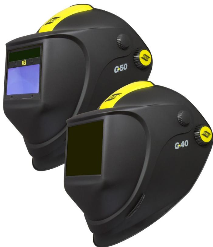
G40 & G50 sind kombinierte Schweiß- und Schneidhelme bei welchem der G40 ein passives Mineralglas und der G50 eine Blendschutzkassette (ADF Automatic Darkening Filter) mit Schutzstufeneinstellung von DIN 9-13 im aufklappbaren Visier beinhaltet. Das große Sichtfenster gibt dem Schweißer ein ungehindertes Blickfeld. Die Helme sind im Bereich der Schlagfestigkeitsklasse B eingestuft, dies bedeutet, sie sind für das Schleifen zugelassen.
