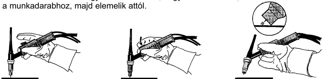
Ívhúzás a LiftArc™ funkcióval. 1. lépés: Érintse hozzá az elektródát a munkadarabhoz. 2. lépés: Nyomja meg a működtető kapcsolót: megindul a kis áramerősségű áram. 3. lépés: A hegesztő elemeli az elektródát a munkadarabtól: ívet húz és az áram automatikusan a beállított értékre nő.
